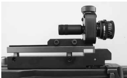
Bild 12: Diopterträger zu Stgw 57 zur Aufnahme schussfester Diopter, diverse Fabrikate
