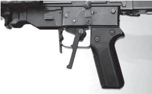
Bild 17: Winterabzug für Linksschützen zu Stgw 57
