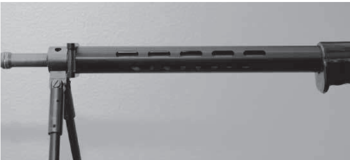
Bild 16: Mantelrohr zu Stgw 57
