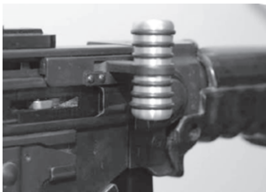
Figura 18: Leva d'armamento anatomica per F ass 57
