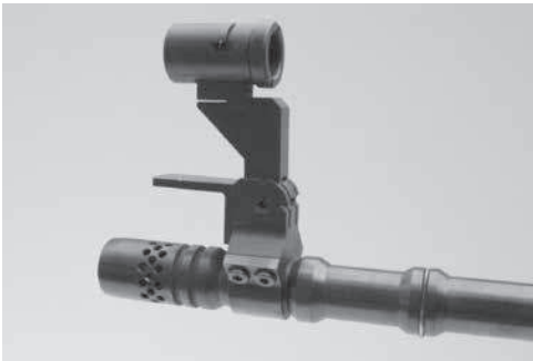
Bild 10: Kornträger als Visierverlängerung (Laufmontage), diverse Fabrikate
