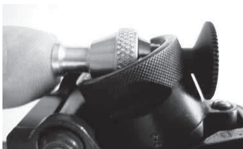
Figura 5: Sistema di filtri colorati Wyss innestabile
