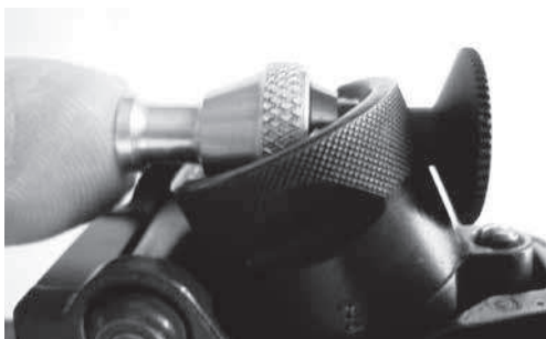
Bild 5: Farbfiltersystem Wyss, aufsteckbar
