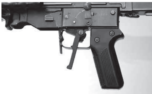
Figura 17: Grilletto ausiliario d'inverno per F ass 57
