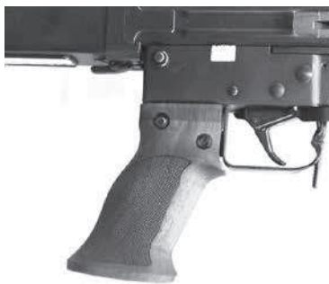
Figura 13: Impugnatura a pistola Tactical per F ass 57
